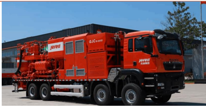
图 12: 国内首台大功率电驱固井车
