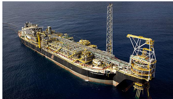
图3: FPSO (浮式生产、储储、卸料系统)
