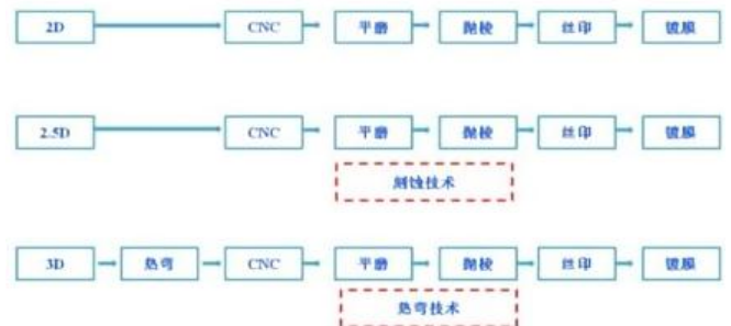
图 21: 2D/2.5D/3D 制造工艺主要差别
