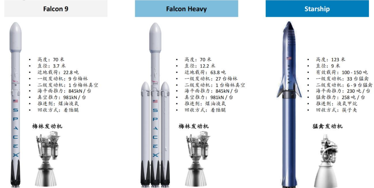
图：SpaceX猎鹰9号与星舰（V2）简图，详细参数可见下页
