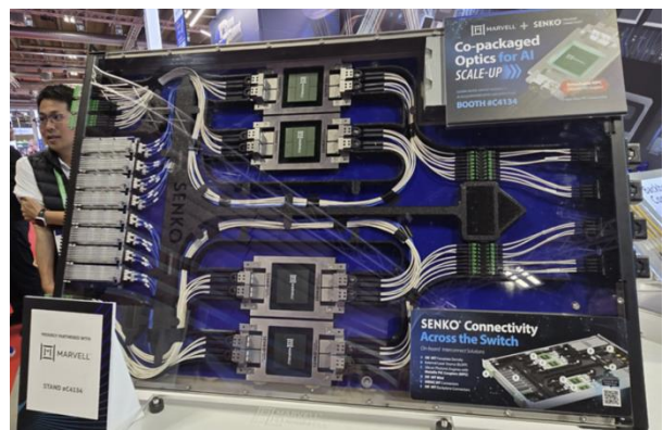
图 22: SENKO 和 Marvell 联合开发的 CPO 服务器托盘
