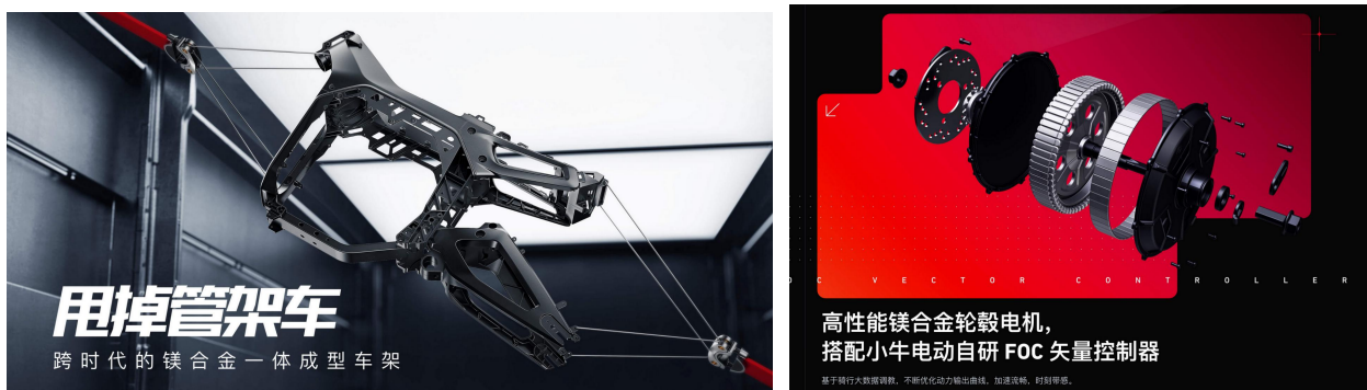
图 21：小牛 SQi 系列采用航空级镁合金一体压铸车架
