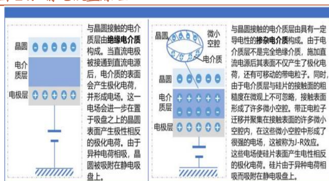
图 24: 静电吸盘原理
