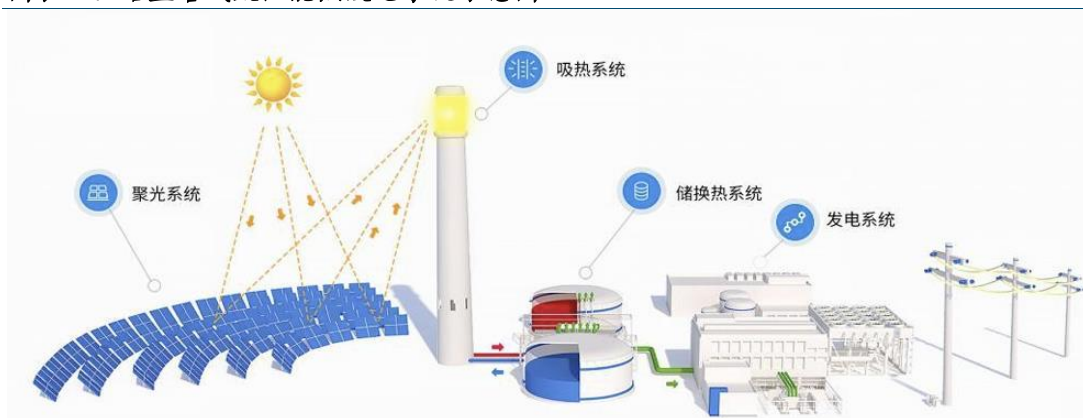
图表48：熔盐塔式太阳能热发电系统示意图
