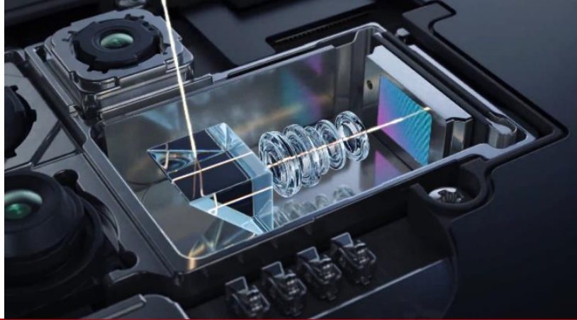
图18：潜望式光学变焦镜头示意图
