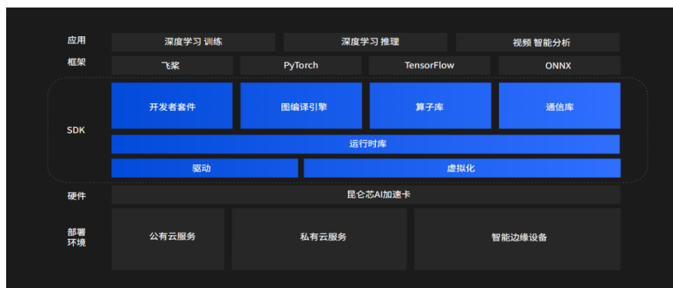
图8：昆仑芯 SDK 可以提供从底层驱动环境到上层模型转换等全栈的软件工具
