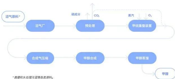
图 31: 生物甲烷制甲醇工艺流程图
