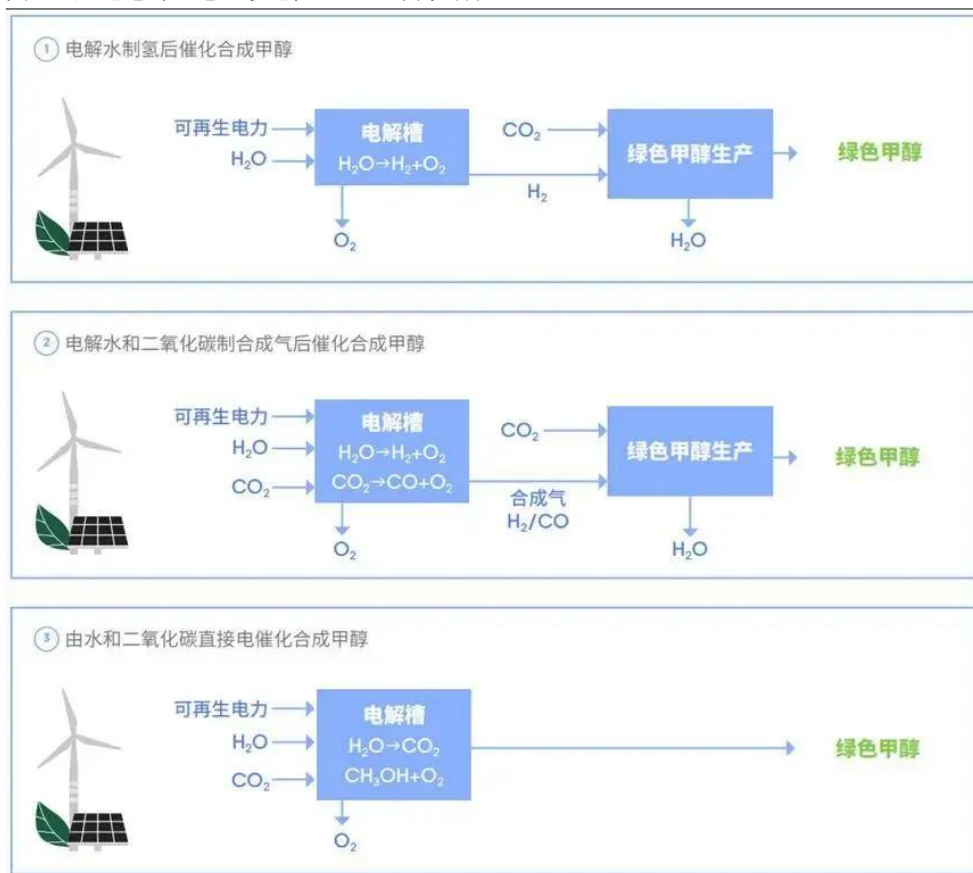
图 33：通过电解和电化学过程生产 e-甲醇的方法
