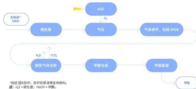
图 32: 生物质气化制甲醇工艺流程图
