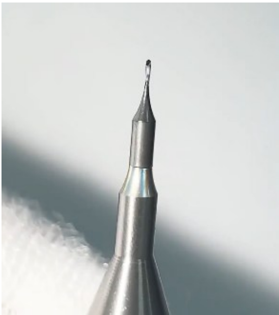
图：PCD钻针仅钻头部分为金刚石材料
