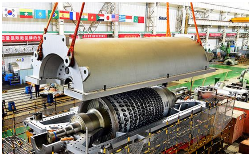
图16 公司 AV140 轴流压缩机组，可用于压缩空气储能领域
