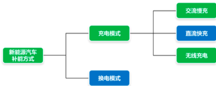
图 3：新能源汽车的补能有换电和充电两种形式
