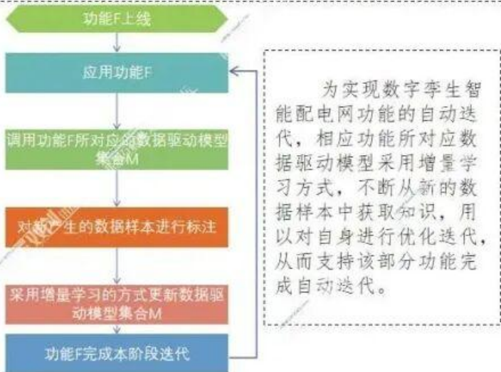
数字孪生智能配电网结构图谱自动更新流程
