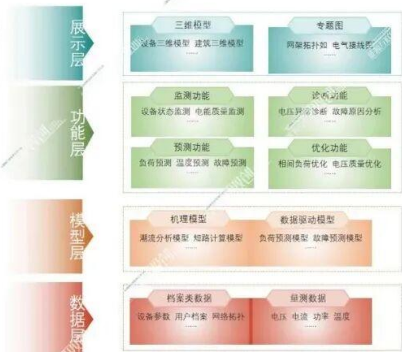
智能配电网数字孪生计算架构
