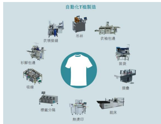
图表55: 公司现代化中心自动化 T 恤制造相关机械设备
