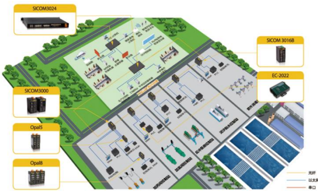
图26: 净水厂生产自动化解决方案拓扑图
