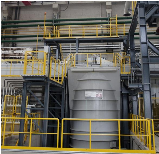
图表20： 公司 VIM-VIDP 1000 型 6 吨真空感应炉
