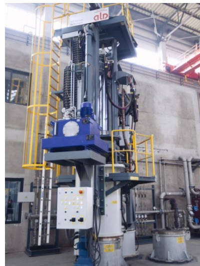
图表21： 公司 VAR L660 P6 型 6 吨真空自耗炉
