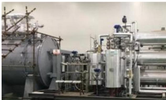
图27: ITER 屏蔽模块热氦检漏设备
