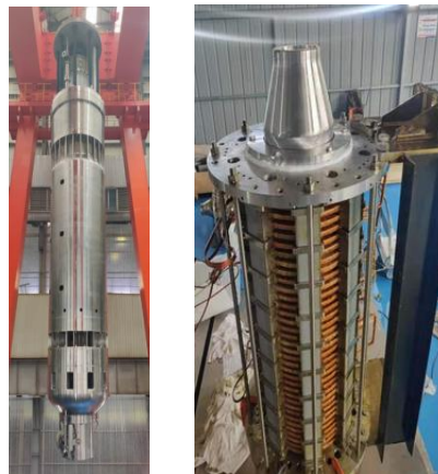
图36: 钠冷快中子反应堆一回路主循环泵(左) 液态金属反应堆用电磁泵(右)
