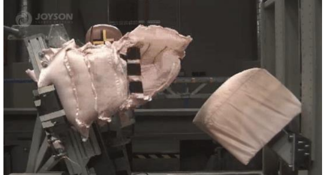
图13：均胜安全开发出环抱式安全气囊
