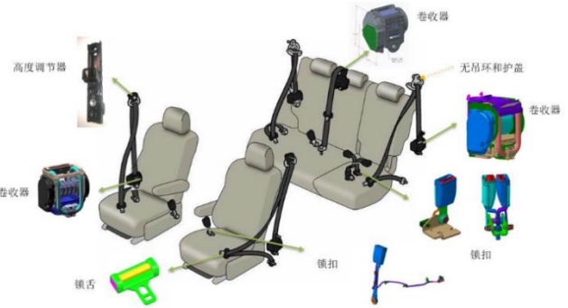
图10：安全带包含卷收器、织带、高度调节器等
