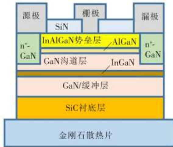
图13: 金刚石散热片结构示意图
