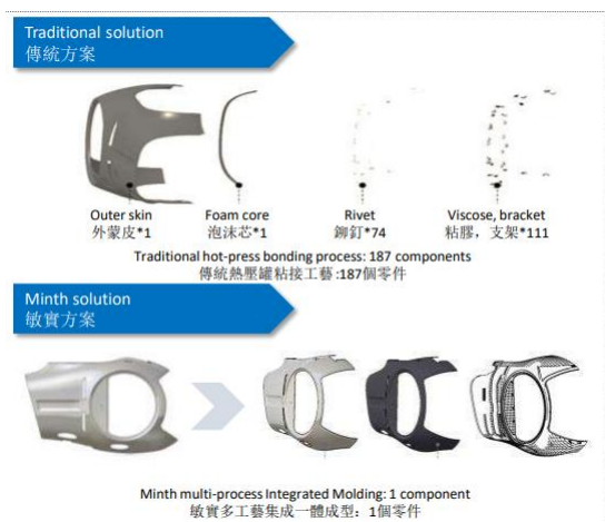
图55：公司机体产品通过多工艺集成一体成型
