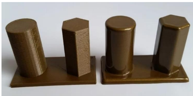
图表53: 丙酮抛光后打印痕迹减弱且更具光泽的 ABS
