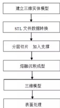
图表14: FDM 3D 打印运作基本原理
