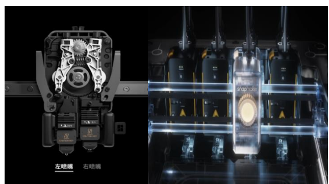
图表29: 拓竹 H2D 双喷头 (左) 与 Snapmaker U1 四喷头 (右)
