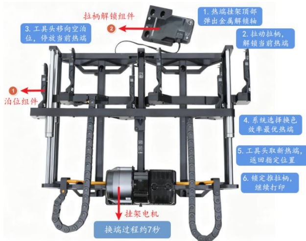
图表32：拓竹 H2C 热端切换过程耗时约 7 秒
