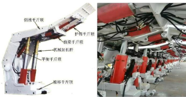
图27：液压支架千斤顶与液压软管分布
