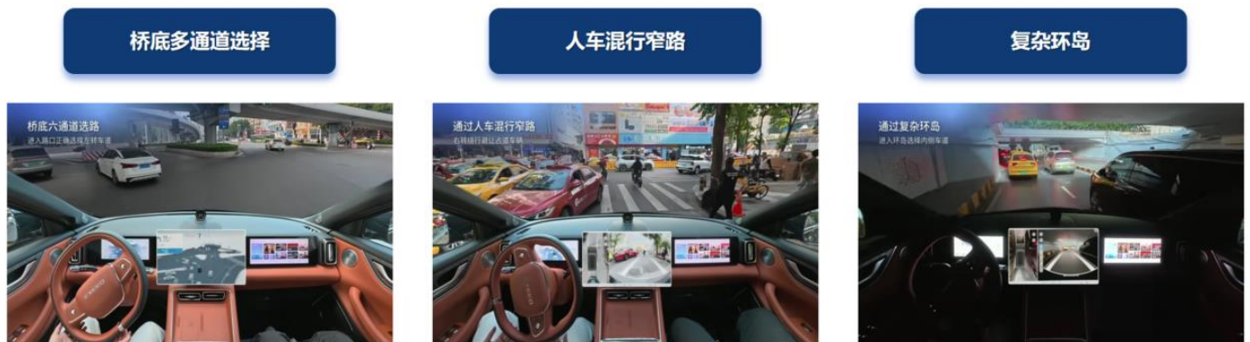
图表7: 地平线 HSD 基于一段式端到端可应对多种复杂交通场景
