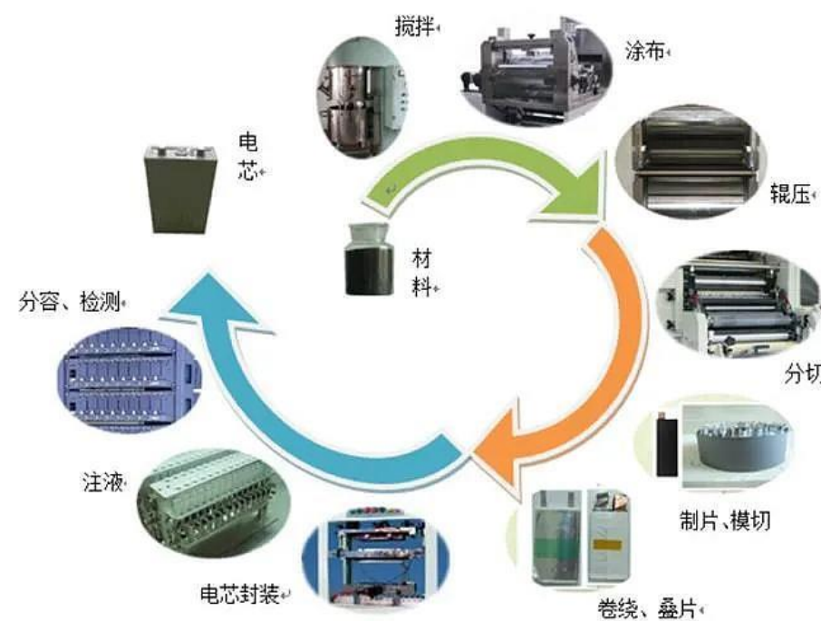
图 12: 锂电池生产制造流程
