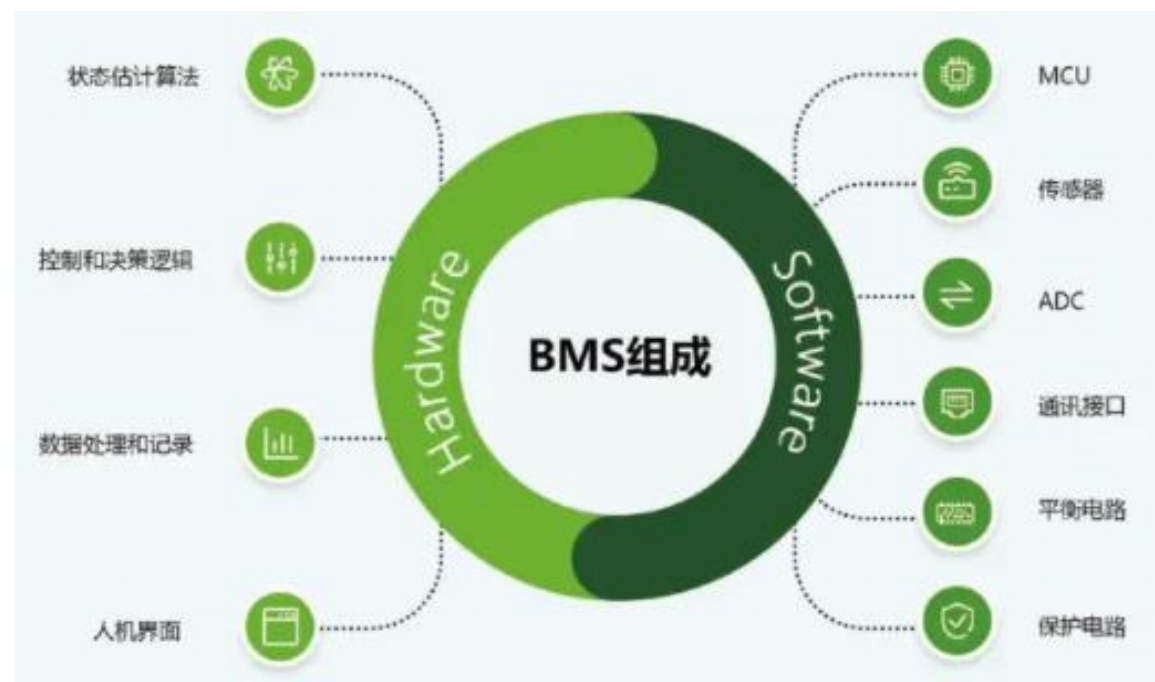
图 13: BMS 电池管理系统的组成
