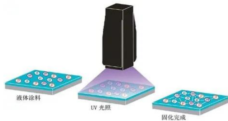
图 21: LED-UV 印刷原理图
