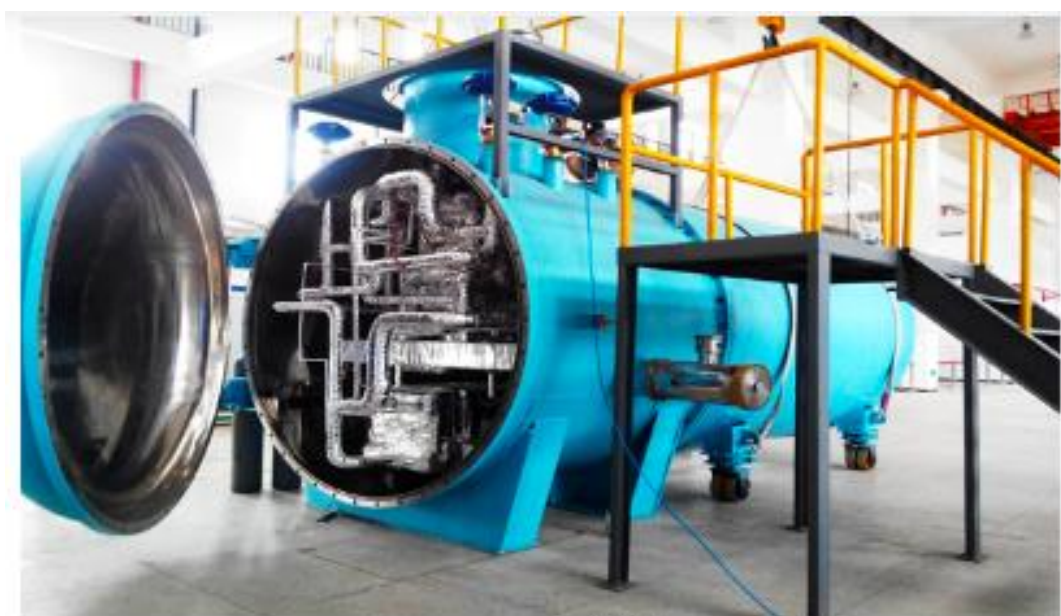
10kW@20K氮制冷机
