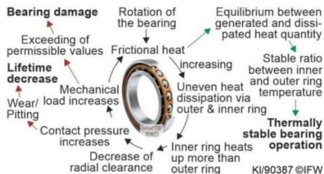
电机轴承的损坏过程
