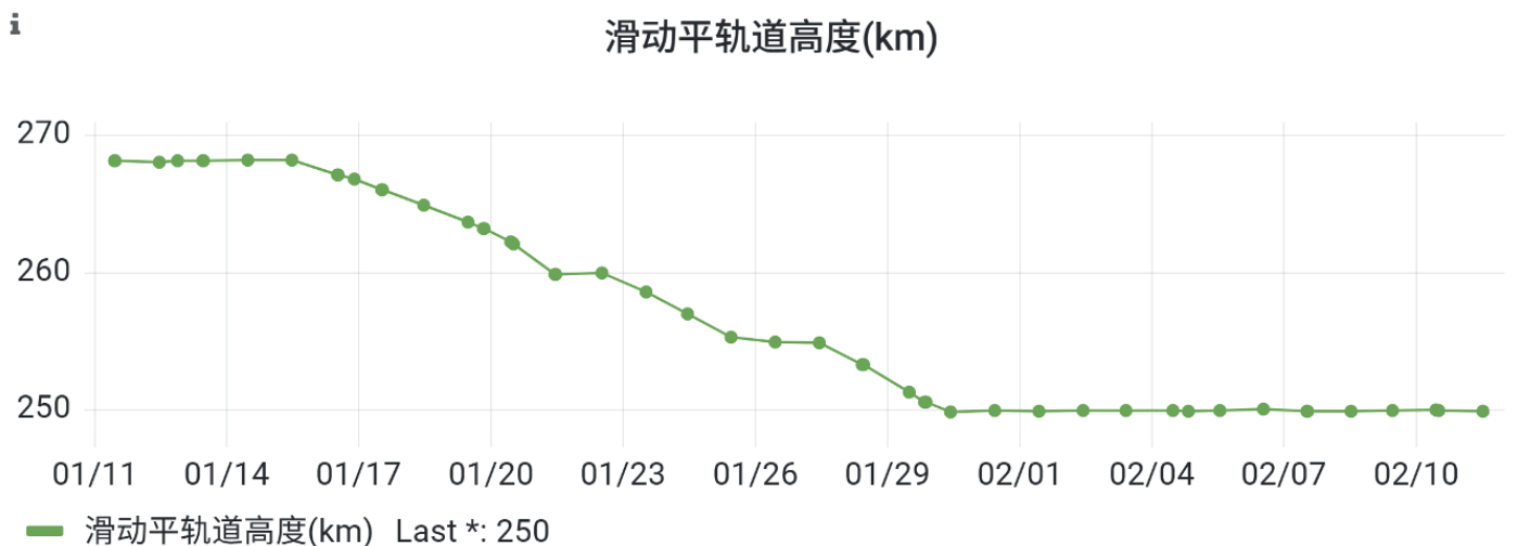
图表47: 赛思倍斯乾坤一号高度演变轨迹(268.13km→250km)实测数据图
