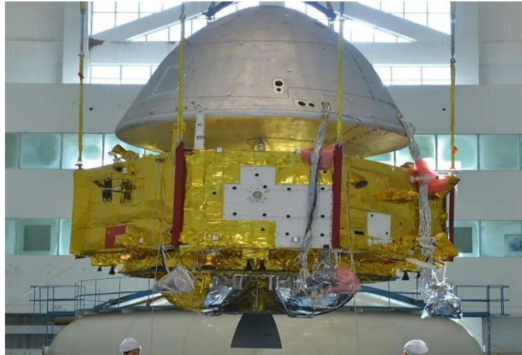
图表30：天问一号采用微弧氧化热控涂层
