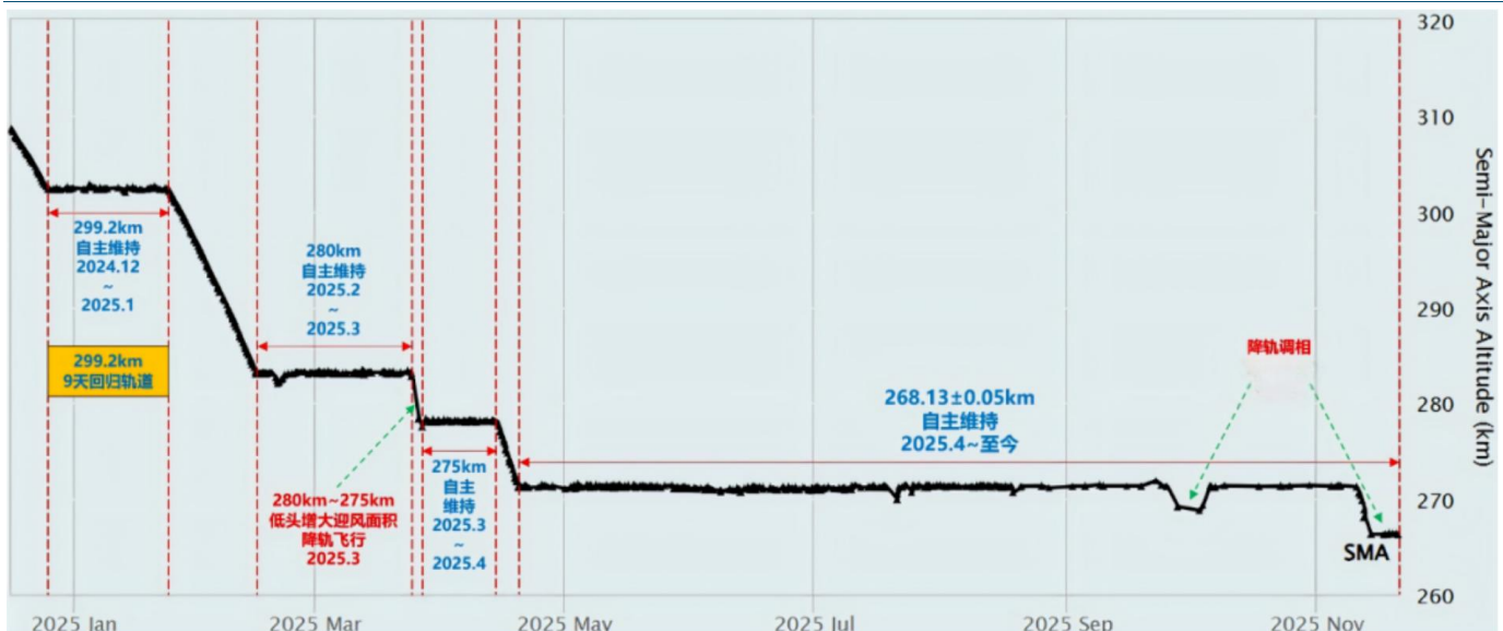
图表57: “乾坤一号”卫星平台自主运行能力和高精度的轨道控制能力
