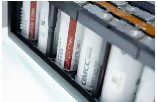
图46：公司的储能电芯采用 GMCC 的超级电容
