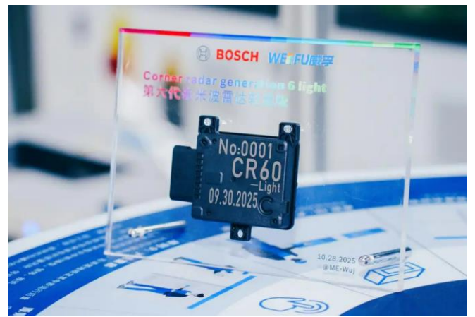
图47：公司第六代毫米波角雷达轻量版
