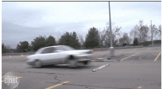
图57：雷克萨斯全主动悬架可以跳跃避开障碍物
