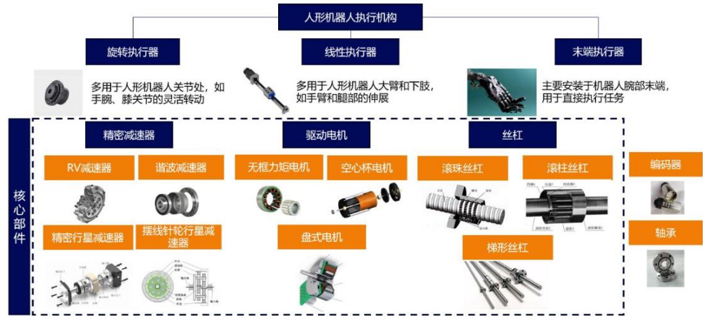
图表 16：人形机器人三大执行机构及其中的核心部件
