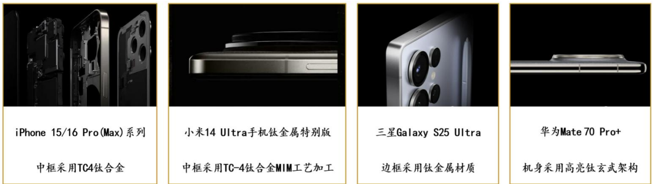
图表 34：多个主流手机厂商使用钛合金中框
