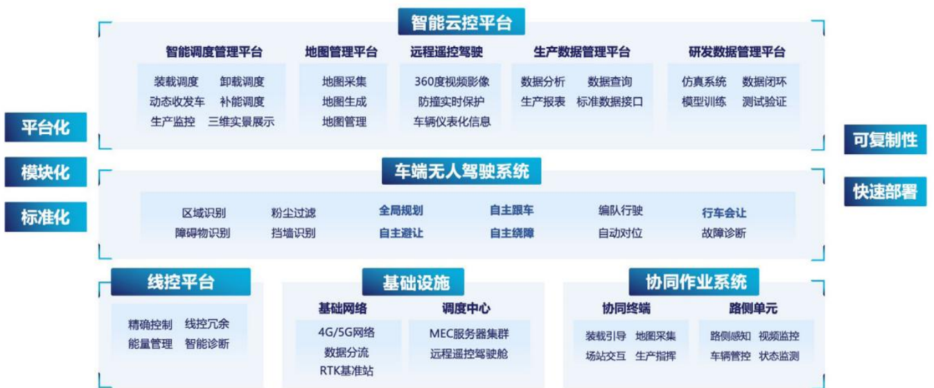
图 5：露天煤矿无人驾驶运输解决方案
