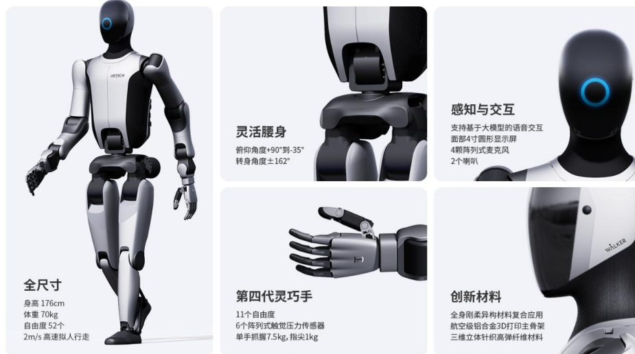
图 13：优必选全新一代工业人形机器人 Walker S2
