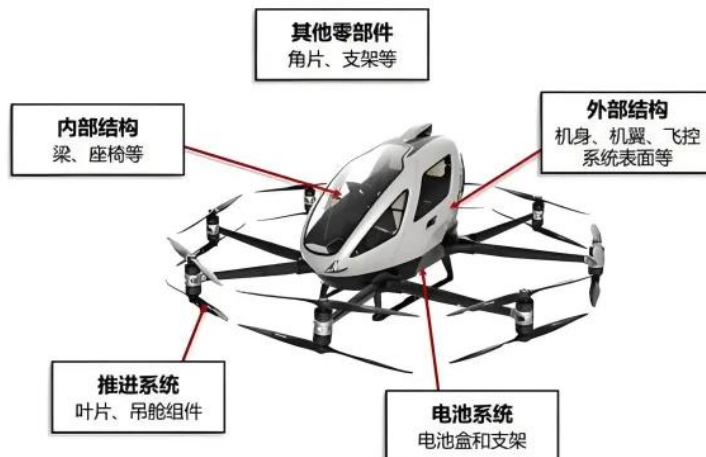
图 8、碳纤维复合材料几乎用于 eVTOL 的所有部件
