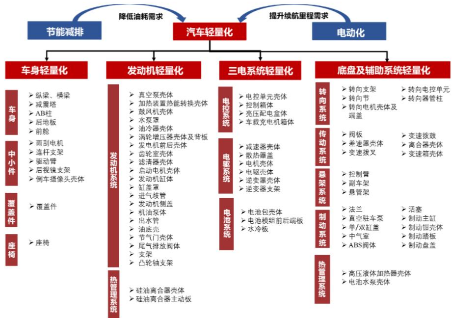
图表 23: 铝合金压铸件广泛应用于汽车的车身系统、发动机系统
