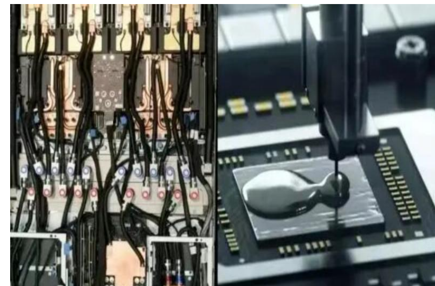
图：液态金属散热方案需定制化设备
