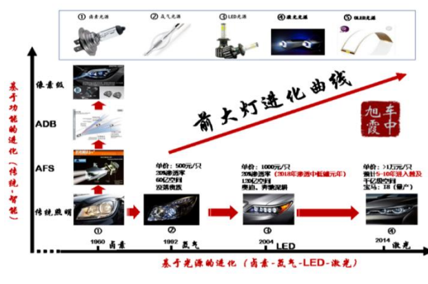
图12: 汽车前大灯技术升级路线
