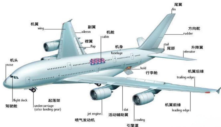
图：大飞机机体结构主要组成
