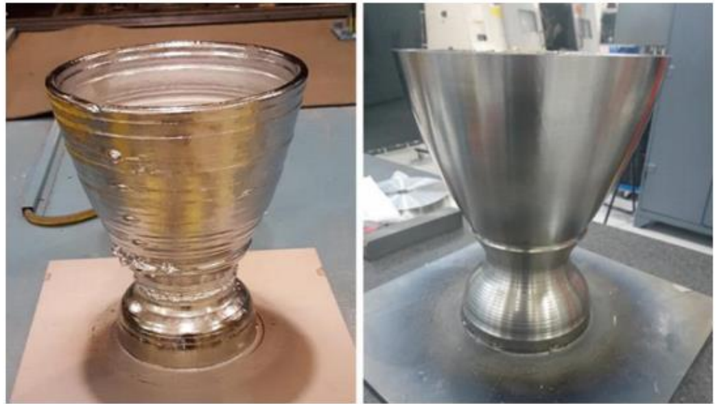
图表32: EB-DED 实现了 100%材料利用率且沉积速率较高
