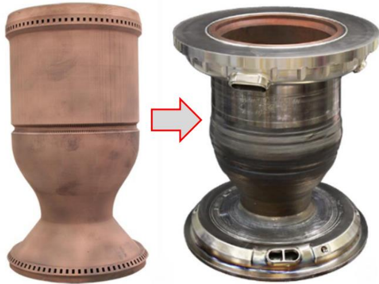
图表24: DED 可在铜合金上继续沉积因科镍来制造外套层
