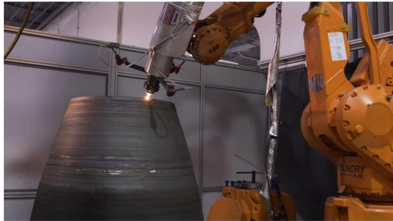
图表22: DED 配套工业机器人实现大尺寸零部件加工
