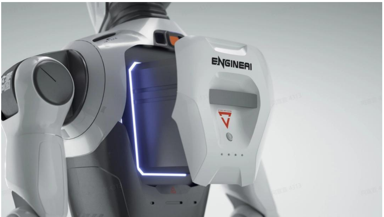
图 11：众擎 T800 人形机器人搭载固态动力电池，可实现 4-5 小时的稳定续航
