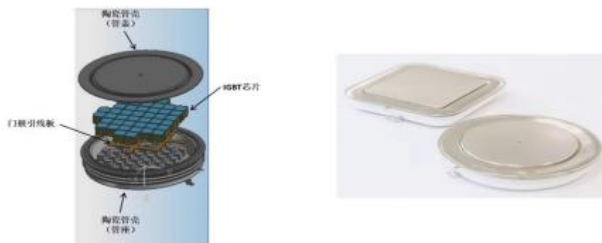
图3：平板压接式 IGBT 器件内部结构和实物图示
