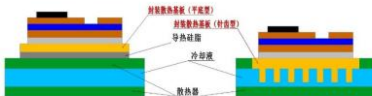
图4：采用平底型封装散热基板（左）和针齿型封装散热基板（右）的 IGBT 结构截面图
