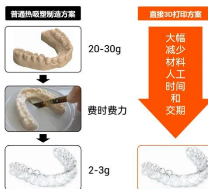
图26：直接 3D 打印技术使得生产流程更加简洁高效
