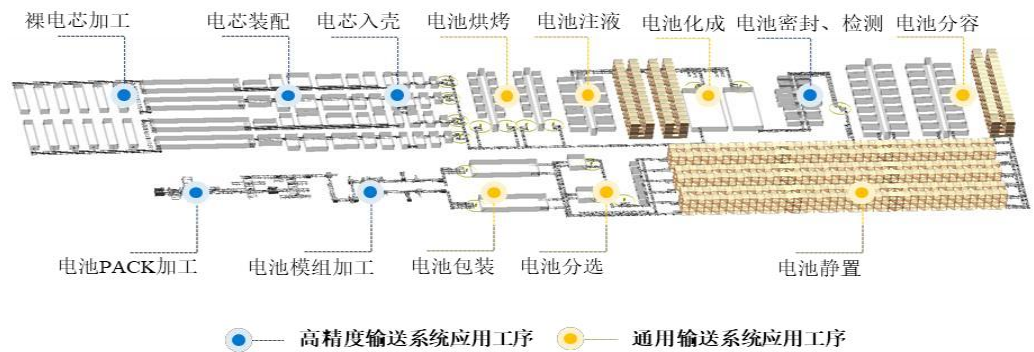
图27：公司智能输送系统在新能源电池生产各环节的应用
