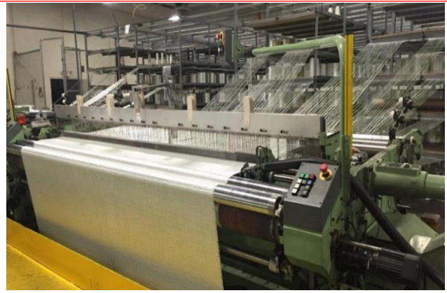
图 3：玻璃纤维织布机织布图
