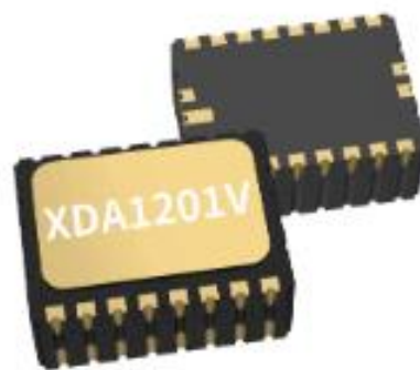
图 12：芯动联科 XDA1201V-高性能 X 轴 MEMS 加速度传感器
