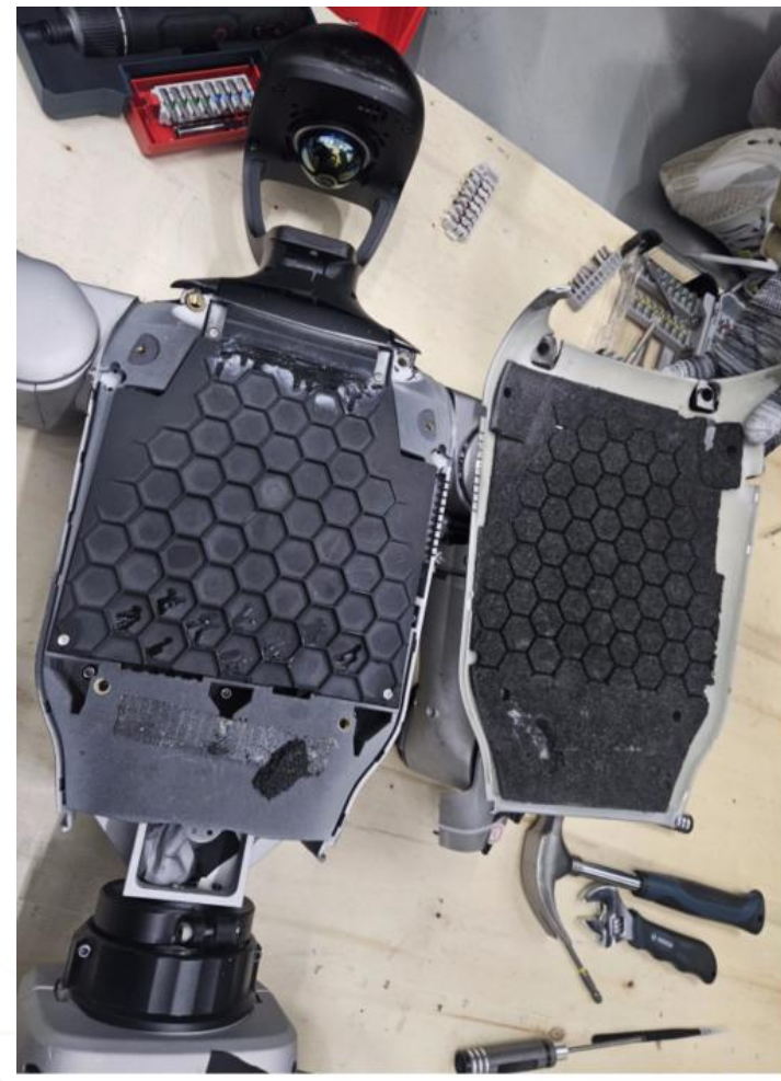
图表39：躯干大面积采用工程塑料
