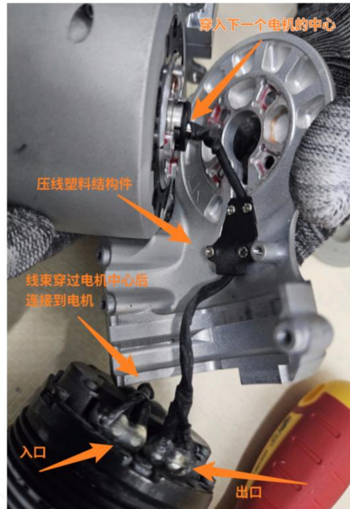
图表29：关节间线束连接示意图
