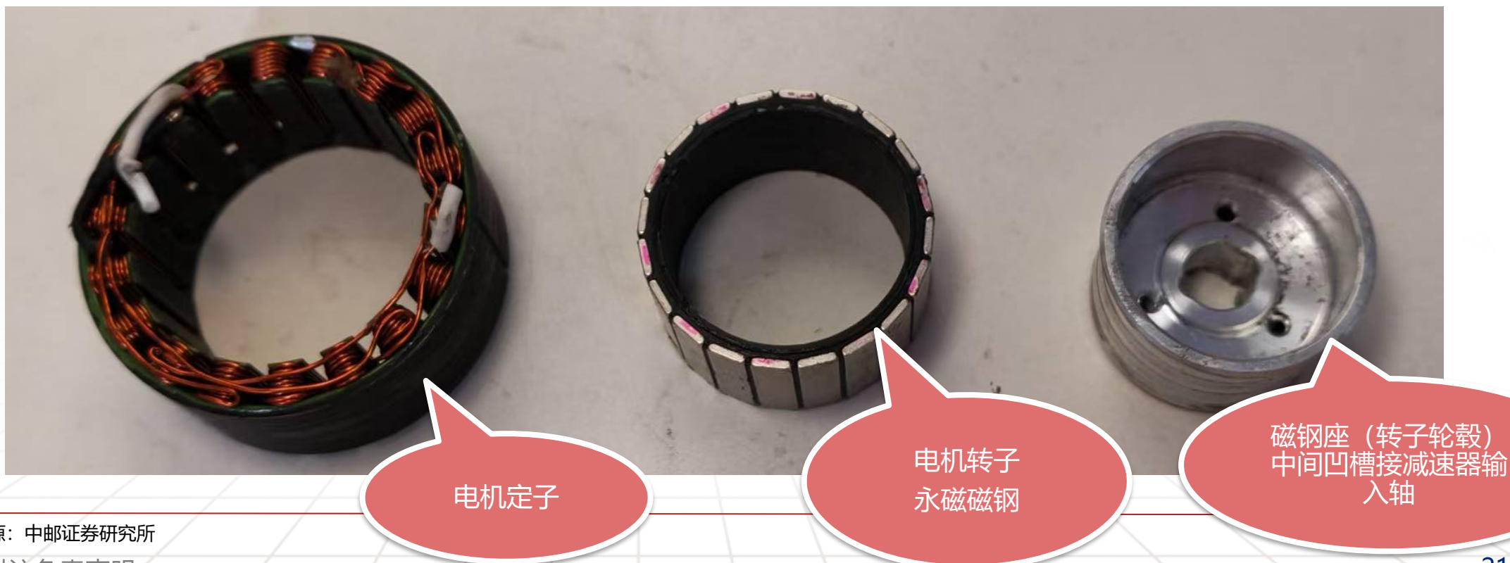
图表14：小关节局部零部件图---电机
