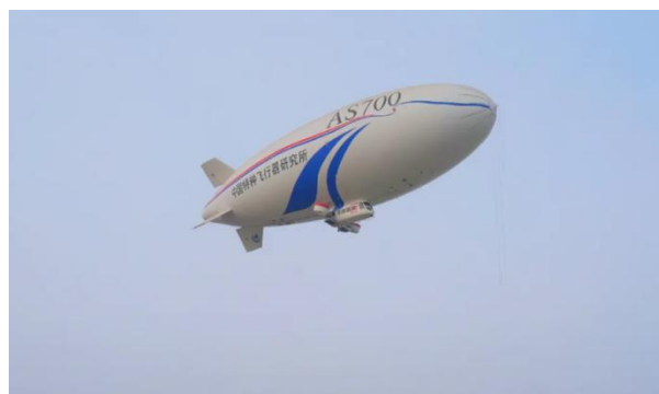
图2：我国自主研发电动型载人飞艇AS700D完成科研首飞
