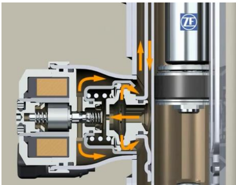
图13：CDC 电磁控制阀结构
